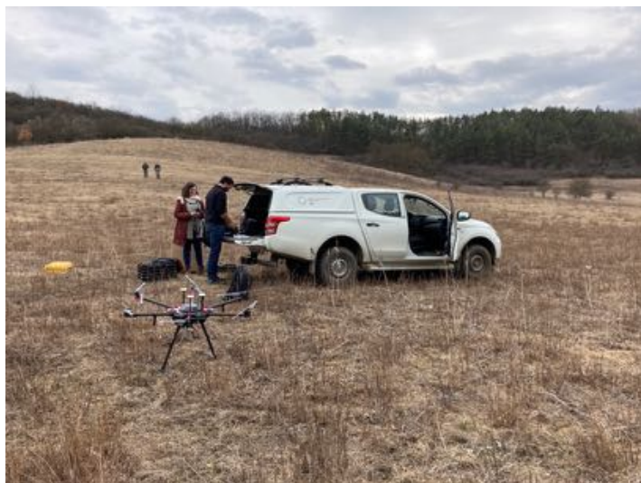
6. sz. kép: LiDAR felvétel készítése drón segítségével
